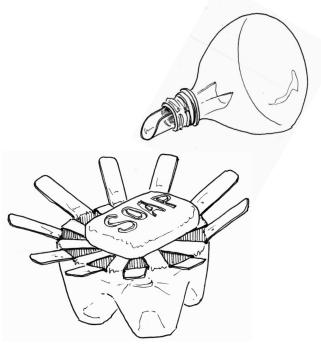
『石けん皿』 底面五つの出っ張りに 合わせて5方向に穴を開ける。 それらの中点にも穴を開け、 さらにその中点にも開ける。 穴は合計20カ所です。 間隔が均等になるように注意 してください。 穴から約40ミリ上で ボトルを水平に切る。 約40ミリ 穴に向かってハサミで 切れ目を入れる。 互い違いに折り曲げ、 底面に水抜きの穴を 開ける。 水抜き穴 外側のベロは 角を落とす。 (ケガをしないため) 完成
